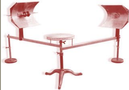
GONIOMÈTRE CM (ca 1895) F = 10 \text{ GHz} ; \lambda = 2,5 \text{ cm}
